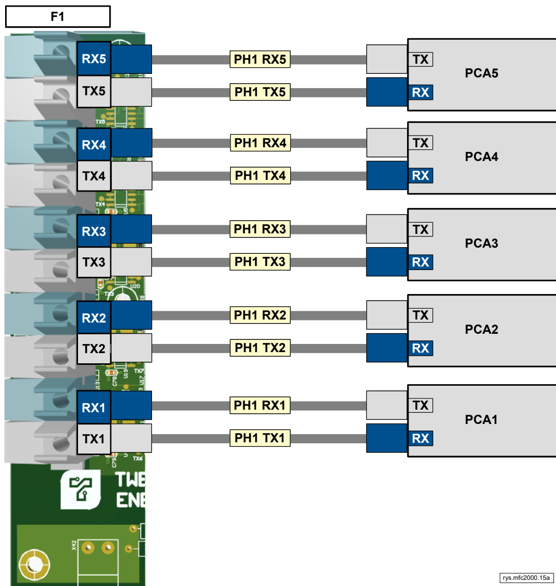
Rys. 37. Połączenia światłowodowe między obwodem PCB MFC2000/01 a modułami mocy PC - faza 1
