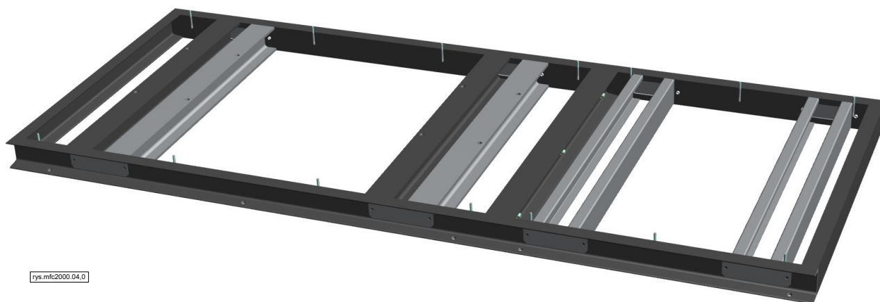
Rys. 6. Widok połączonych cokołów
