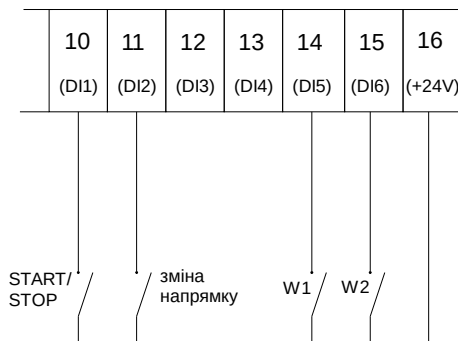
Рис. 5.4. Схема підключень на клемній колодці X1 для трьох постійних швидкостей
