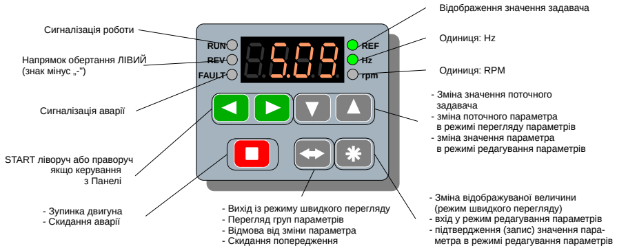
Рис. 3.1. Панель керування, основні функції кнопок і дисплея
