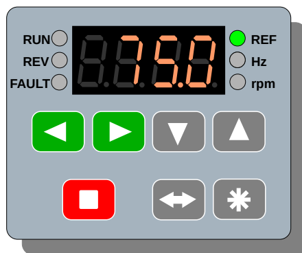
Рис. 6.2. Зміна значення задавача регулятора PI
