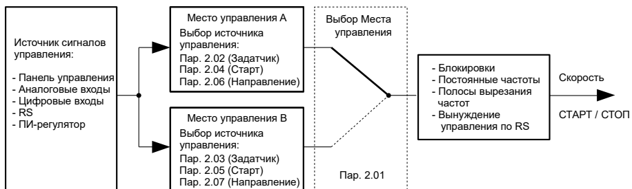
Рис. 5.1. Упрощенная структура управления преобразователем AFC200
