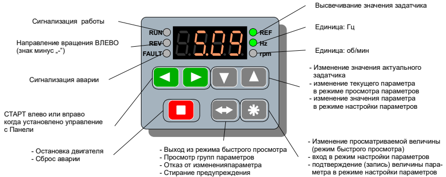
Рис. 3.1. Панель управления, основные функции кнопок и дисплея
