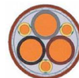
Рис. 2.2 Переріз кабелю HELUKABEL TOPFLEX-EMV-3 PLUS-2YSLCY-J 600/1000 B
