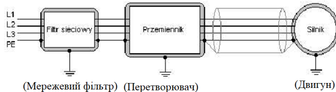
Рис. 2.3 – Спосіб з'єднання окремих складових системи електроприводу
