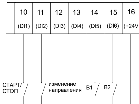
Рис. 5.4. Схема клеммных соединений X1 для трех постоянных скоростей
