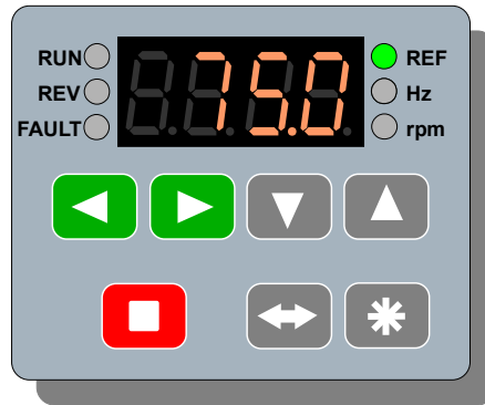
Рис. 6.2. Изменение значения задатчика ПИ-регулятора (задатчик с клавиатуры: пар. 2.60 = 0)
