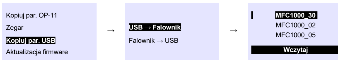
Рис. 1.11. Копіювання налаштувань параметрів: USB-накопичувач → частотний перетворювач
