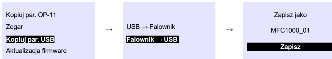
Рис. 1.10. Копіювання налаштувань параметрів: перетворювач частоти → USB-накопичувач
