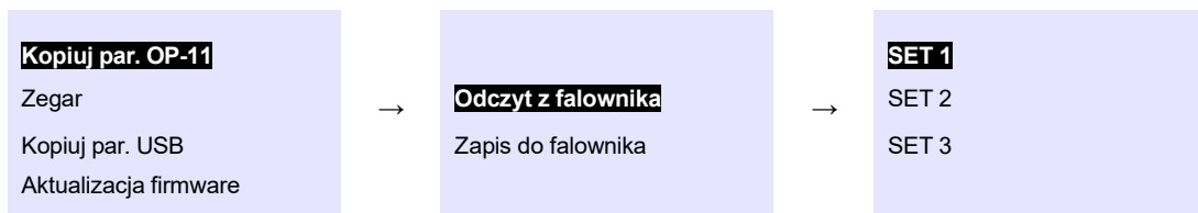
Рис. 1.8. Копіювання налаштувань параметрів: перетворювач частоти → панель керування
