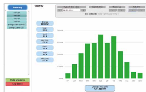
Rys. 1. Okno podglądu parametrów pracy i danych historycznych inwertera PS100 produkcji ZE TWERD
