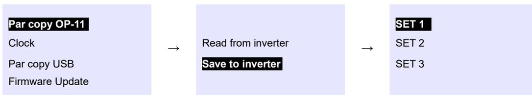
Рис. 1.9. Копирование настроек параметров: панель управления → инвертор
