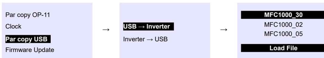
Рис. 1.11. Копирование настроек параметров: USB-накопитель → преобразователь частоты
