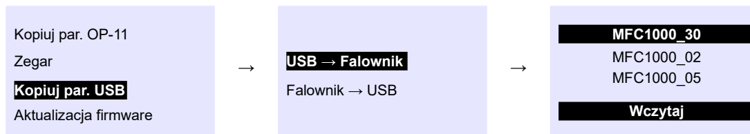
Rys. 1.11. Kopiowanie nastaw parametrów: nośnik USB → przemiennik częstotliwości
