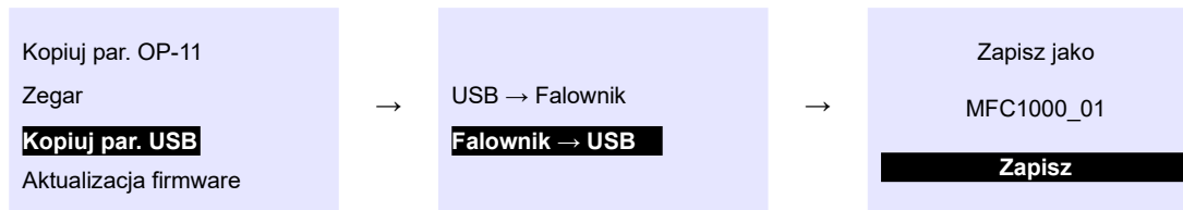
Rys. 1.10. Kopiowanie nastaw parametrów: przemiennik częstotliwości → nośnik USB
