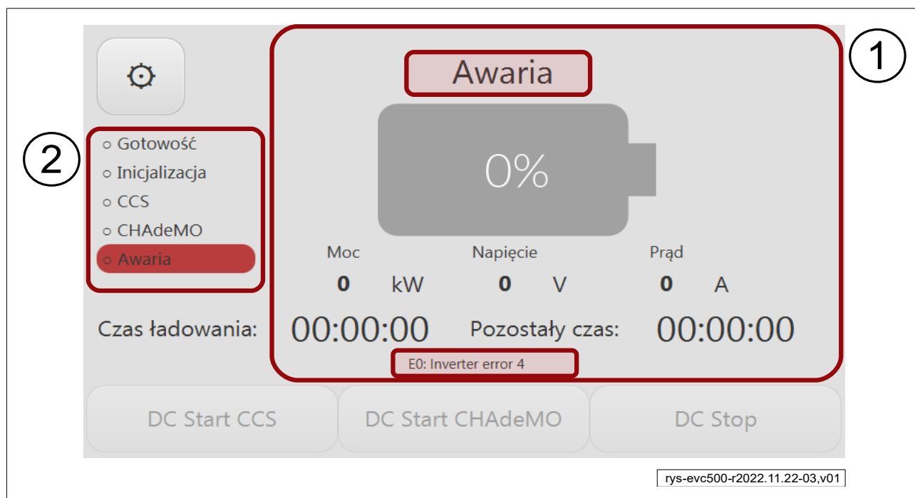
Rys. 2.12. Stan awarii urządzenia
