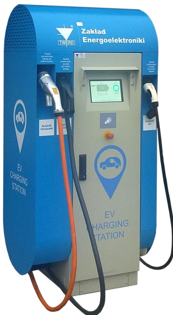
Rys. 15. Wolnostojąca stacja ładowania TEVS1000 wyposażona w punkt szybkiego ładowania DC o mocy do 50 kW (CCS lub CHAdeMO) oraz punkt ładowania AC o mocy do 22 kW
